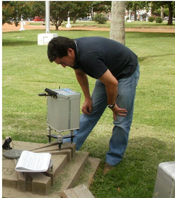
**Figura 12: Gravímetro Scintrex™ Autograv CG-5.
