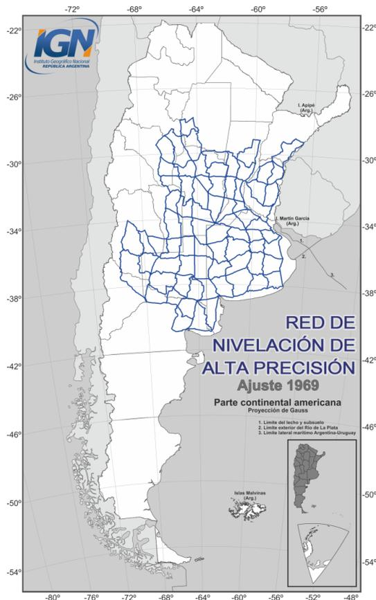
Fig. 5. Primer ajuste de la red de nivelación de Alta Precisión realizado por la USATC en 1969
