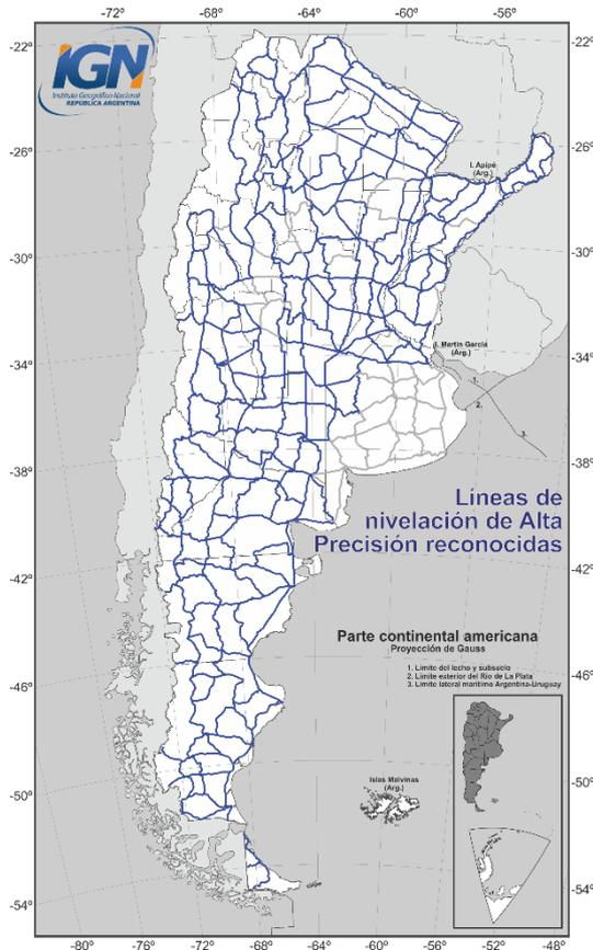
Fig. 29. Líneas de la red de nivelación de Alta Precisión que han sido reconocidas
