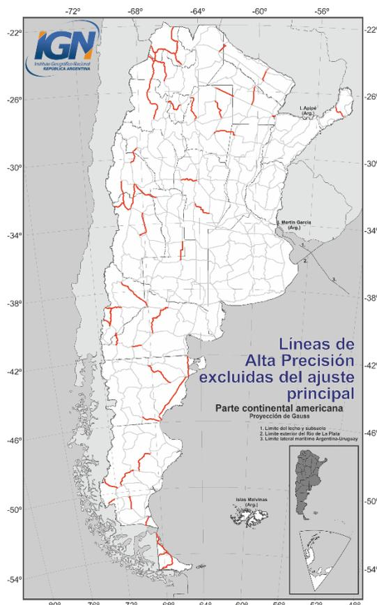
Fig. 41. Líneas de nivelación de la red de Alta Precisión que no fueron incluidas dentro del ajuste por mínimos cuadrados
