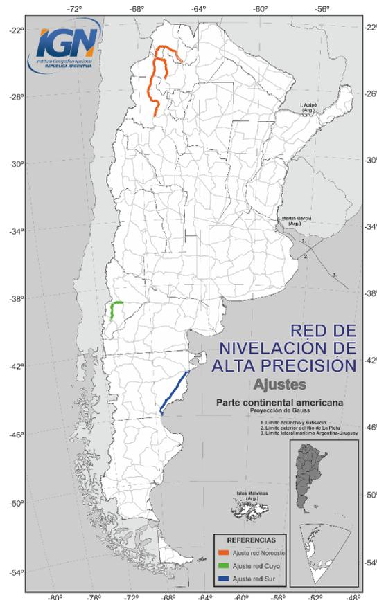
Fig. 40. Diferentes ajustes realizados a la red de nivelación de Alta Precisión: a) en color gris red principal; b) en color rojo red Noroeste; c) en color verde red Cuyo; y d) en color azul red Sur
