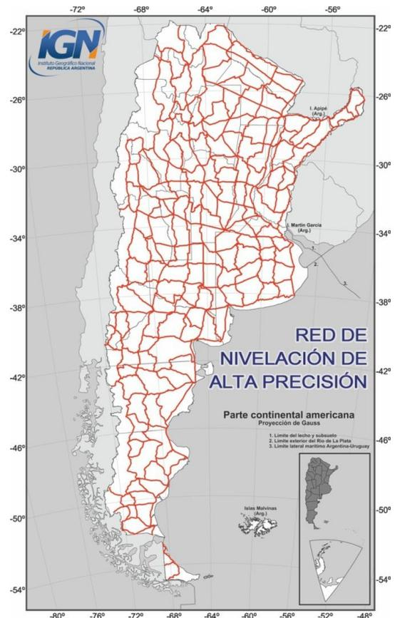
Fig. 6. Red de nivelación de Alta Precisión de la República Argentina
