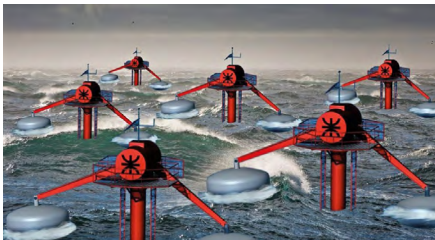
FIGURA 6. Ilustración de un parque marino de convertidores undimotrices. Fuente: PELISSERO et al. (2020)
