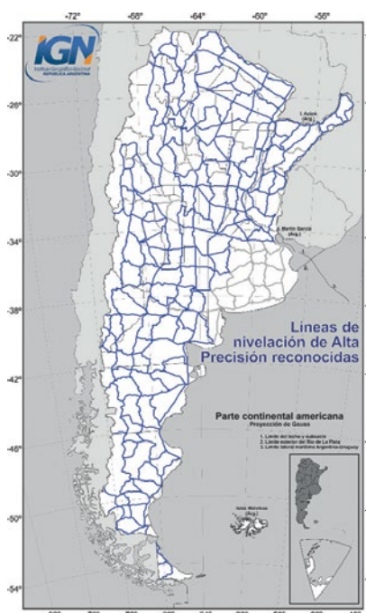
FIGURA 12: Líneas de la red de nivelación de alta precisión que han sido reconocidas
