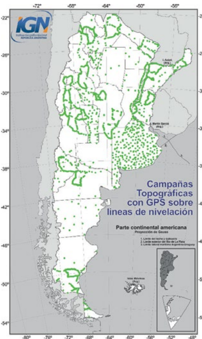
FIGURA 13: Puntos altimétricos medidos con GPS diferencial doble frecuencia
