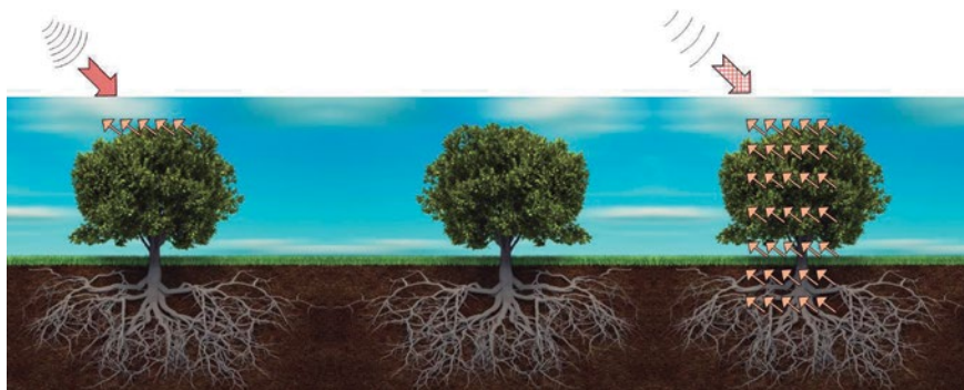
FIGURA 1. Diferencias en la capacidad de penetración según la banda de microondas, banda X (a la izquierda), banda L (a la derecha).
