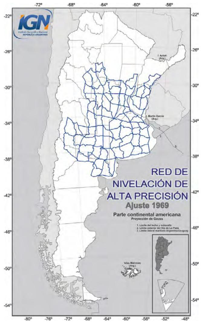
FIGURA 5 Primer ajuste de la red de nivelación de alta precisión realizado por la USATC en 1969
