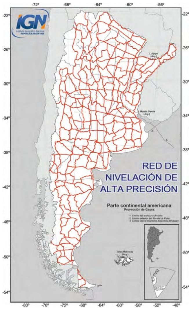
FIGURA 6: Red de nivelación de alta precisión de la República Argentina
