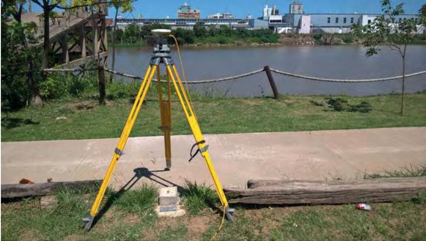
FIGURA 3. Punto fijo materializado en el puerto Puerto de Santa Fe para el referenciamiento de las escalas.
