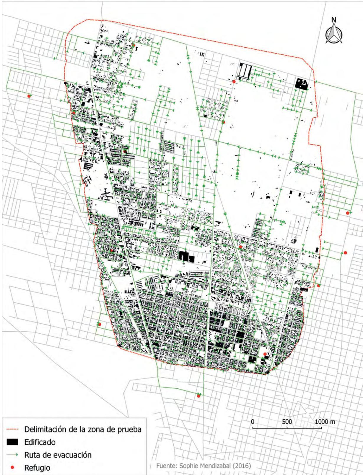
FIGURA 3: Plano de evacuación de la zona de prueba en el norte de Santa Fe.
