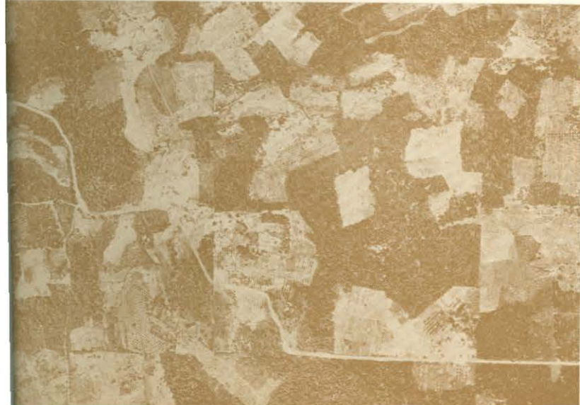
Nº 5 — Fotografía escala 1:20 000 (escala de toma). Altura de vuelo 2.400 mt. Cámara Wild R. C. 5 (foco 11,5 cm.) (Sector comprendido en la fotografía Nº 4)
