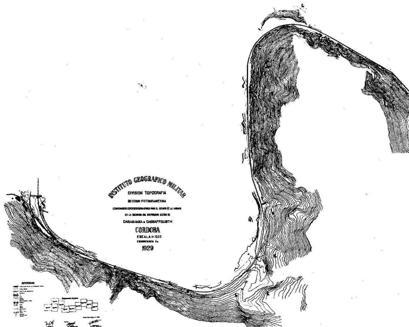
Reproducción de un sector del levantamiento estereofotogramétrico efectuado para la Dirección General de los F. C. del Estado; en la Quebrada del Río Primero "Córdoba"
